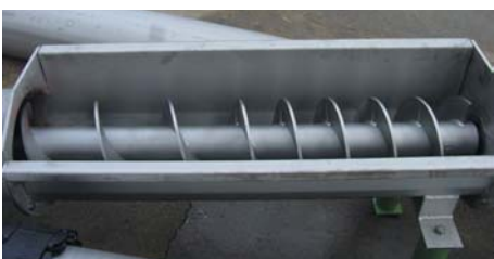
Transportarea sigură fără înfundare: Depinde de pasul corespunzător al șnecului!
