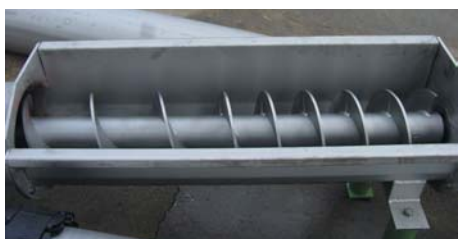
Spolehlivý transport bez ucpávání: záleží na správném vinutí šneka!
